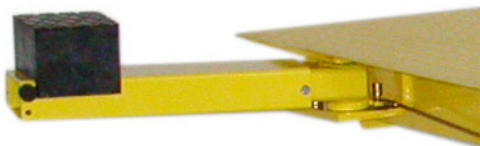
Los brazos de elevación plegables están dentro del área de huella del vehículo levantado, para la seguridad de las personas que trabajan cerca del vehículo
