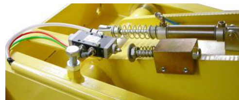
Arresto di sicurezza all'uscita della fossa, contro il danneggiamento della parte inferiore del veicolo, e prima di entrare in fossa
