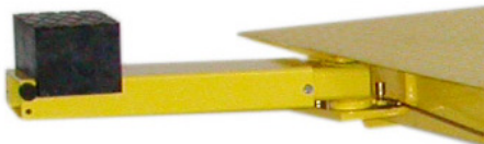
Les bras de levage télescopiques restent à l'intérieur de l'encombrement du véhicule soulevé, pour la sécurité des personnes travaillant à proximité du véhicule
