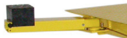
Les supports de levage télescopiques restent proches de l'encombrement du véhicule soulevé, pour la sécurité des personnes qui travaillent près du véhicule.
