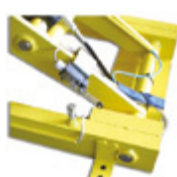
Arrêt de sécurité pendant la descente avec activation du signal acoustique
