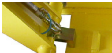
Sécurité mécanique de l'élévateur
