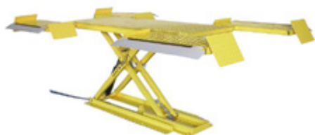
Soulèvement standard par supports de prise sous roues
