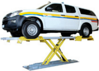
Elevación estándar a través de soportes de apoyo de ruedas
