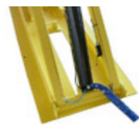
Dispositivo de seguridad inferior durante la bajada con activación de señal acústica
