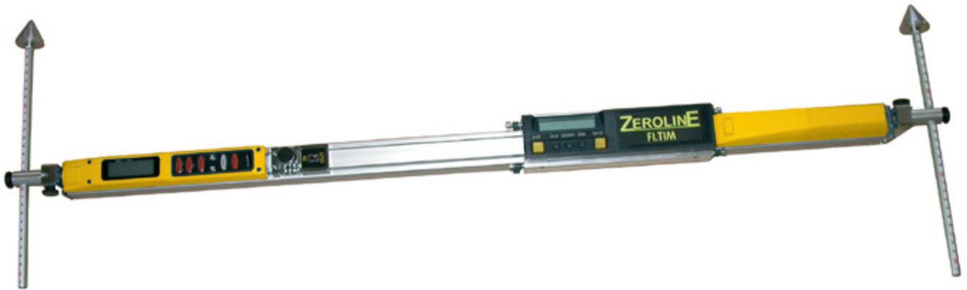
Zeroline - longueur, largeur, diagonale et hauteur sont mesurés de façon digitale avec la précision numérique. Zeroline peut travailler avec n'importe quelle inclinaison - en poussant le bouton de réglage va se créer le plan de référence zéro même si la voiture n'est pas en position horizontale. Il est indiqué à mesurer la carrosserie / les parties mécaniques / l'alignement des roues etc.
